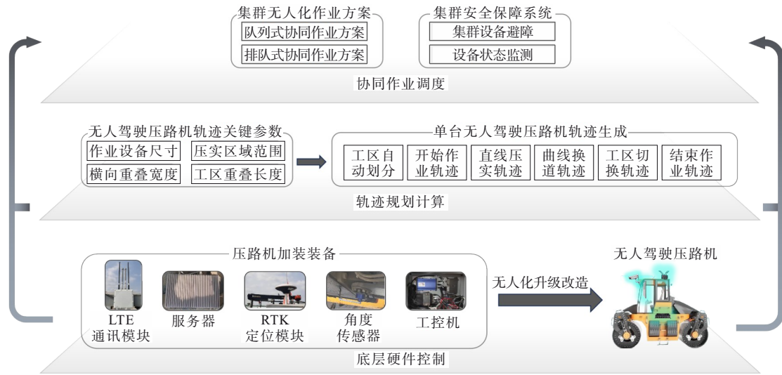
图 1 无人驾驶压路机集群作业技术架构
