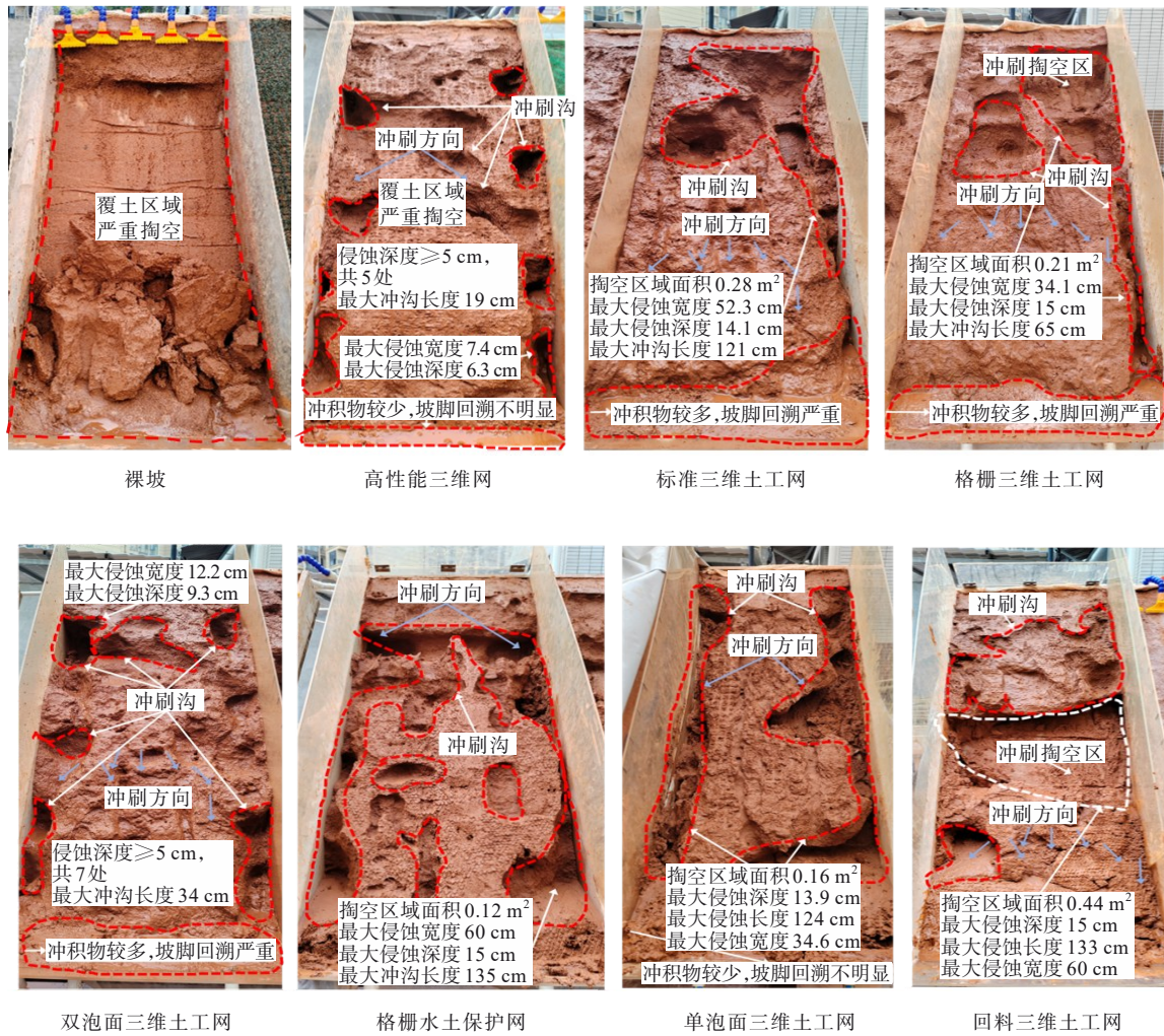
(a) 裸坡与不同三维网防护下的坡面冲刷特征
