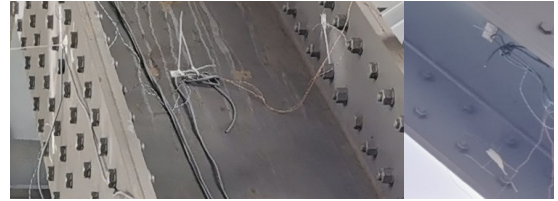
(a) 受拉杆应变片位置(1#、2#贴在加固件,3#、4#贴在原构件)
