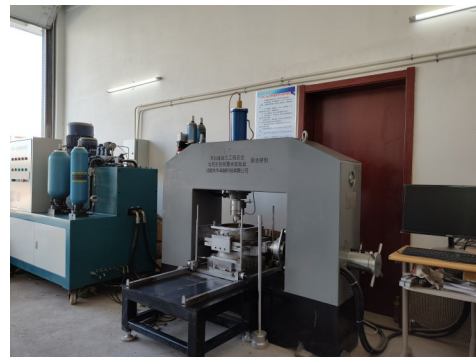
图1 动态界面剪切试验仪 DWZJ-3
