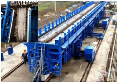
图2 有横隔板T梁模板
