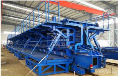
图1 无横隔板T梁模板
