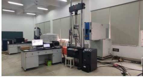
图3 疲劳试验加载装置
