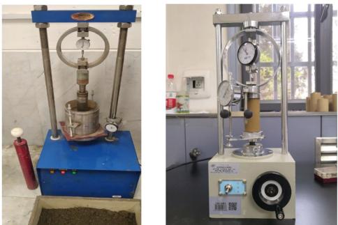
(a) CBR 试验 (b) 无侧限抗压强度试验
