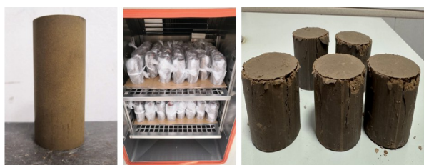
(a) 冻融前试件 (b) 冻融循环 (c) 冻融后加载破坏后试件
