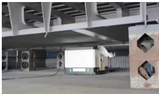
图3 钢箱梁外表面智能喷涂
