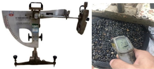
图 5 摆式摩擦系数测定
