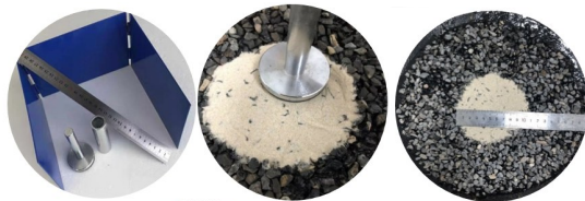
图 4 路面构造深度测定
