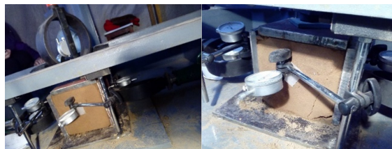
(b) 对面约束状态初始与破坏土样形态图
