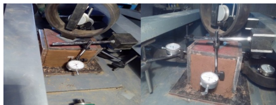
(c) 三面约束状态初始与破坏土样形态图
