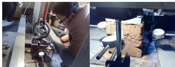
(a) 无侧限状态初始与破坏土样形态图
