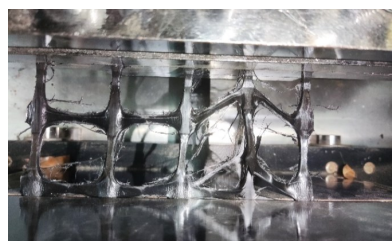
(b) 固废包裹后的拉断破坏
