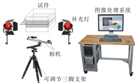
图6 三维数字散斑应变测量系统图
