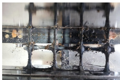
(a) 格栅在黏土中的拔出破坏
