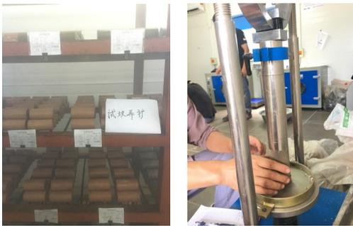
图1 水泥土试样和单轴压缩试验
