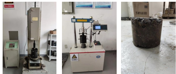
(a) 电动击实仪 (b) 路面材料强度试验仪 (c) 测试后脱模试件
