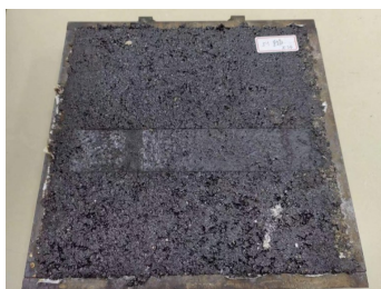
图2 车辙试验试件
