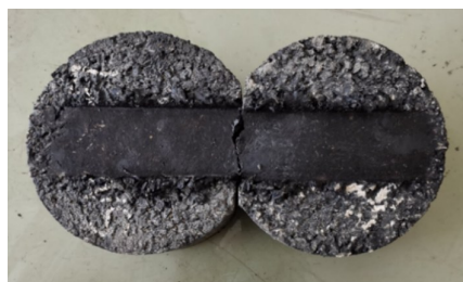
图5 汉堡车辙试验试件
