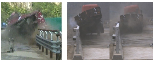
(a) 波形梁护栏 (b) 梁柱一体式型钢护栏
