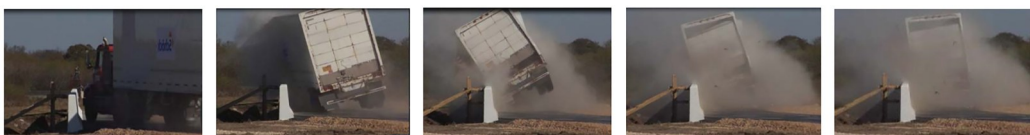
(b) 某大型车碰撞改进型坡面护栏( s=12.5 \text{ cm} 、 b=18 \text{ cm} )试验(2)
