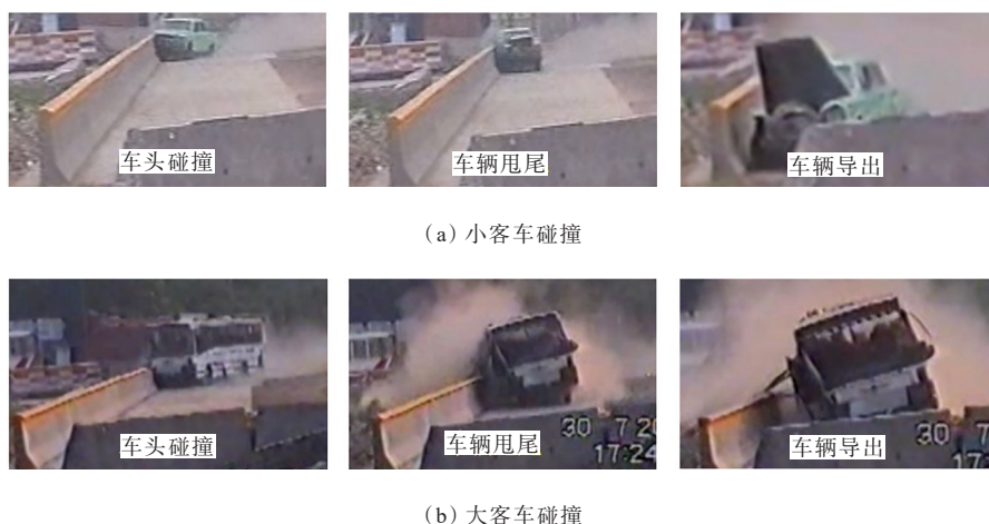
图9 增加阻爬坎的新泽西护栏防护车辆试验
