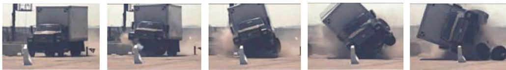
图7 某大型车碰撞新泽西型坡面护栏( s=18 \text{ cm} 、 b=25.5 \text{ cm} )试验结果
