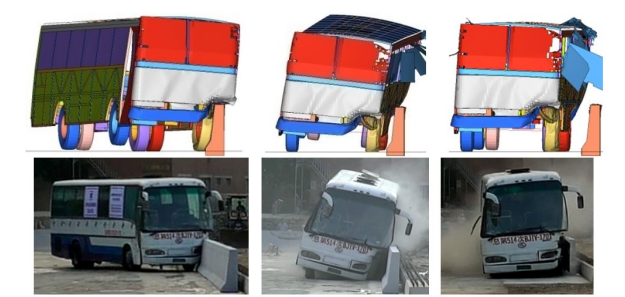
图 3 大型客车碰撞混凝土护栏仿真与试验对比
