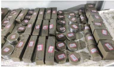
图2 水泥土抗压抗剪抗折试样
