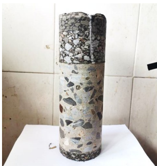
图29 长潭高速公路钻芯试样 [56]
