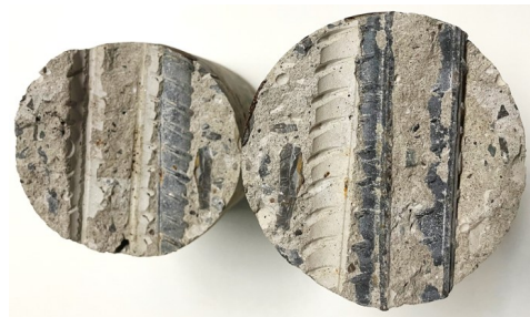
图14 CRC基层钻芯试样图
