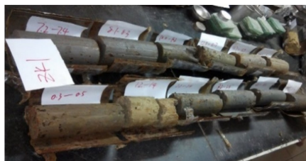
图1 病害路段钻孔软土芯样
