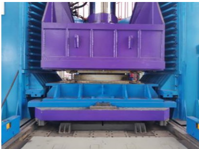
图5 支座力学性能检测
