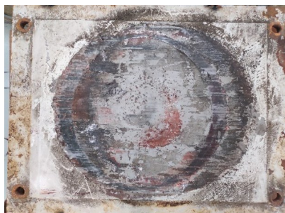
图 3 不锈钢镜面表面磨损状况
