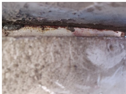
图 2 中间钢板锈蚀状况
