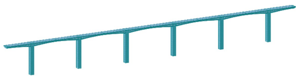
图10 桥梁空间杆系单元有限元模型
