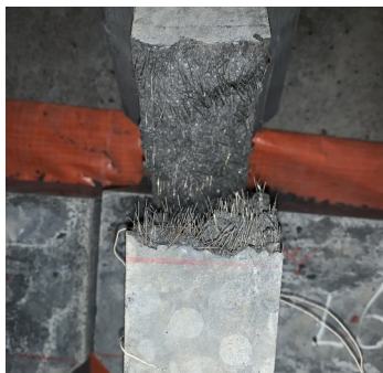
图 5 20 mm 长度纤维 UHPC 断面图
