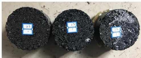
图10 不同空隙率沥青混合料泛白情况
