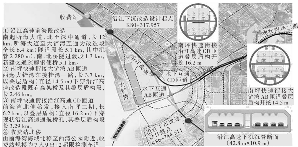
图1 沿江高速公路前海段与南坪快速衔接工程布置图
