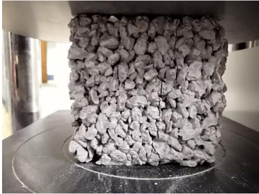
图1 透水混凝土抗压强度测试
