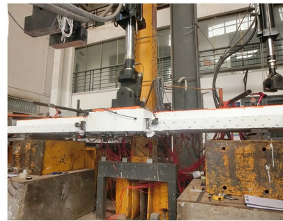
(b) 接缝模型试验装置
