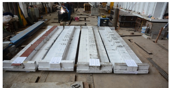
图5 UHPC桥面板足尺试验试件
