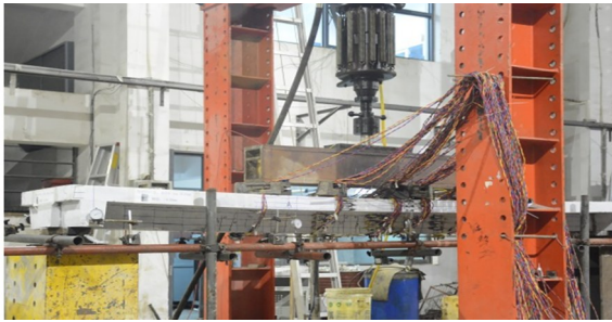
图6 UHPC桥面板试验加载系统
