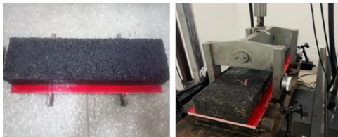
图2 组合结构五点加载疲劳试验
