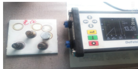
图 1 防水黏结层拉拔试验
