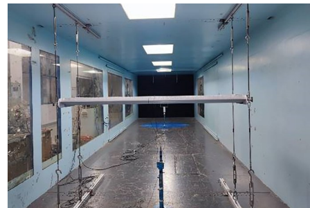
图6 节段模型弹性悬挂系统
