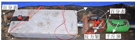
图 2 加载装置
