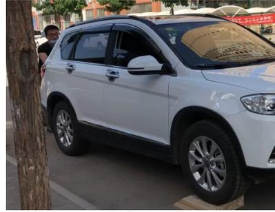
图2 车轮跌落试验
