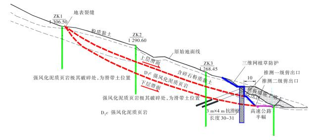
图 5 A 区滑坡处置典型横剖面图(单位:m)
