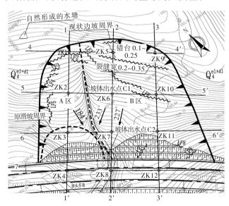
图 3 滑坡工程地质平面图(单位:m)
