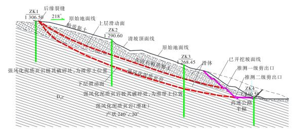
图 4 A 区滑坡典型地质剖面图(标高单位:m)
