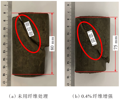
图7 GCS试样破坏形态
