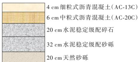
图1 双层沥青路面结构示意图
