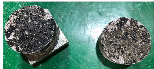
图6 沥青与水泥混凝土表面脱层
