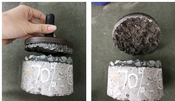
图4 碎石封层与微表处发生层间断裂
