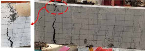
图4 试验梁破坏情况
