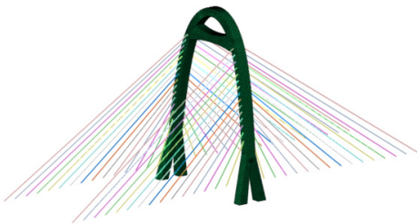
图 5 拱塔实体有限元模型
