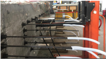
图 5 预应力钢绞线张拉
