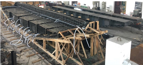
(a) 混凝土梁模板及焊接钢梁
