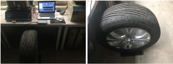
图 4 轮胎自由振动衰减装置
