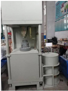
图 1 道路材料振动旋转压实仪
