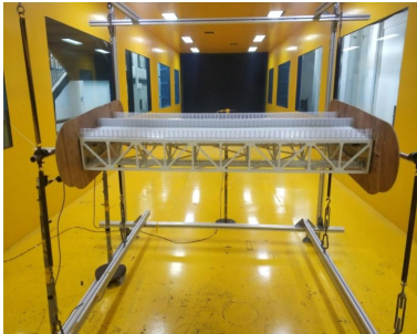
图 5 节段模型试验布置
