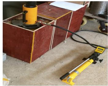
图 2 拉拔试验设备
