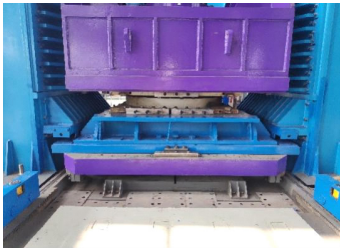
图3 支座摩擦系数试验照片
