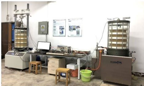
图 1 GDS-DYNTTS 粗粒土大型动、静三轴试验系统
