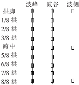
图2 钢波纹板拱桥内壁应变片布设示意图
