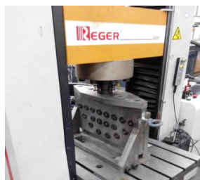
(a) 小试验工装及剪力试验图
