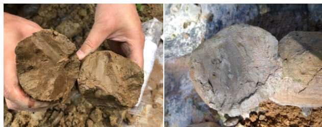
图4 钻孔揭露的滑带土中搓揉、光面及擦痕现象
