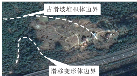
图 1 高速公路开挖边坡滑移变形体及后部巨型古滑坡堆积体卫星影像图
