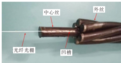
图 1 自感知钢绞线封装设计
