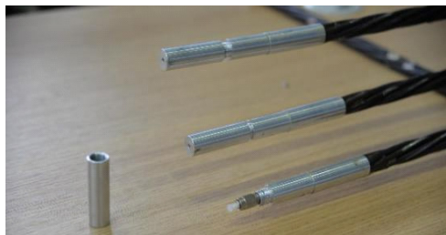
图 2 自感知钢绞线端部封装保护
