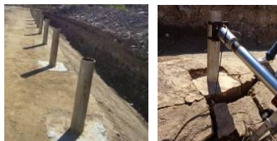
图 4 混凝土加强式立柱单元试验样品与结果
