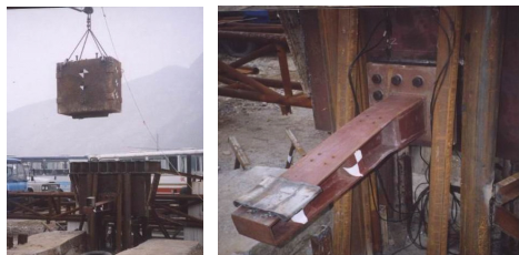
图 6 预埋法兰盘栓接式立柱单元试验样品与结果
