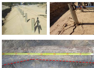
图 3 打桩埋入式立柱单元试验样品与结果
