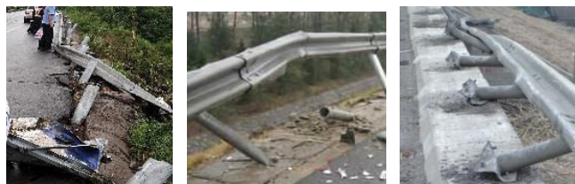
(a) 打桩埋入式立柱 (b) 混凝土加强式立柱 (c) 钢套筒嵌入式立柱
