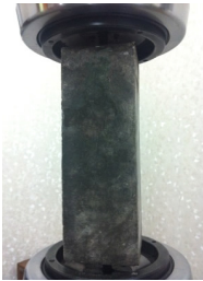
图 3 SFRC 试件安装
