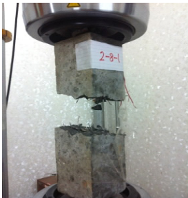
图 5 试件破坏形态
